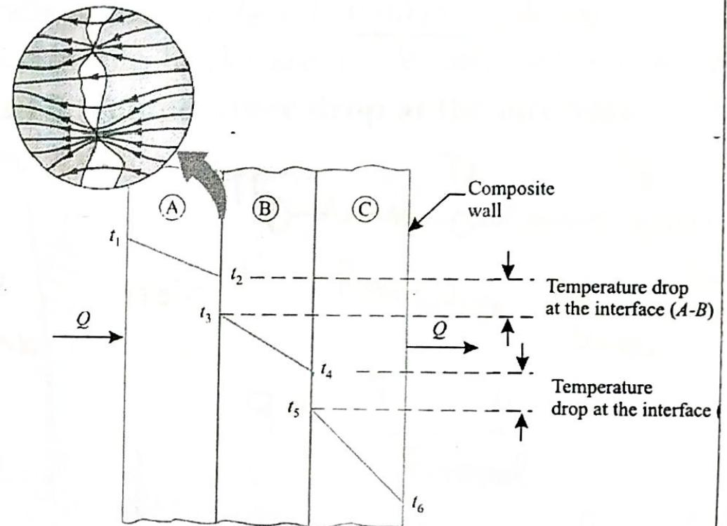
$$(R_{th-AB})_{\text{cont.}} = \frac{(t_2 - t_3)}{Q/A} \quad \text{and} \quad (R_{th-BC})_{\text{cont.}} = \frac{(t_5 - t_6)}{Q/A}$$
